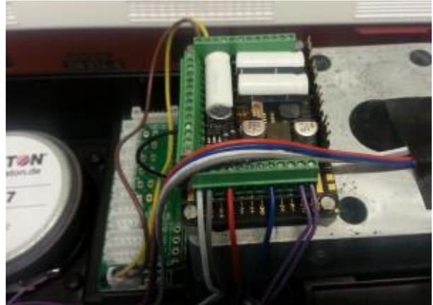
Der Lautsprecher LSFRS7 wird vorher von unten in die vorge-sehene Aussparung montiert. Dazu muss zuerst die untere Abdeckplatte demontiert werden. Die notwendige Schrauben und UScheiben zur Befestigung des LSFRS7 gehören nicht zum Lieferumfang. Entfernen Sie jetzt die Brücken Jumper aus den Führerstands Platinen gemäß PIKO Anleitung. Rücklichter und Führerstandbeleuchtungen können nun separat und digital schaltbar angeschlossen werden.
